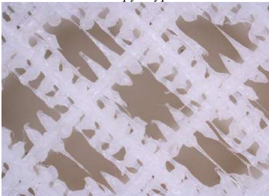
Фиг. 7. Пробен образец с 20% плътност на структурата
