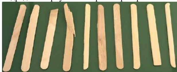
Фиг. 4. Дефектни (негодни) дървени бъркалки
