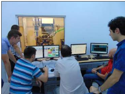
Фиг. 6. Стенд за изследване на качеството на горивата и чистотата на въздуха
