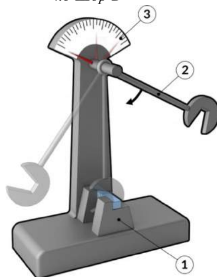
Фиг. 2. Чук на Шарпи; 1-Статив за закрепване на образец; 2- Махало на чука; 3- Скала за отчитане
