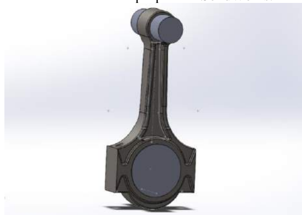
Фиг. 2. Триизмерен геометричен модел на мотовилката, буталния болт и част от колянвия вал
