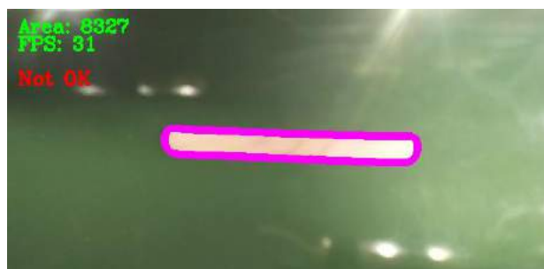
Фиг. 10. Резултат от анализ на негодна бъркалка
