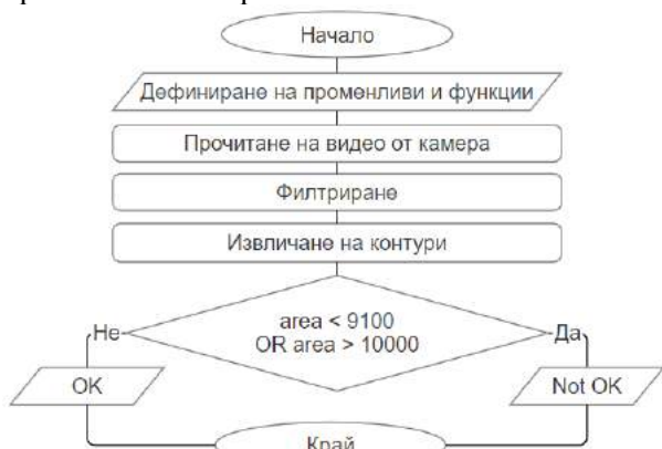
Фиг. 6. Блок схема на алгоритъм за проверка на площта на дървените бъркалки
