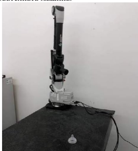
Фиг. 4. Romer Absolute Arm 7320SI със сканирания прозрачен обект
