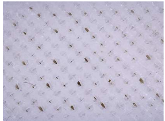
Фиг. 8. Пробен образец с 50% плътност на структурата
