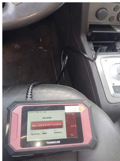
Фиг. 2. Свързване на диагностичен инструмент към конектора на бордовата диагностика на автомобила
